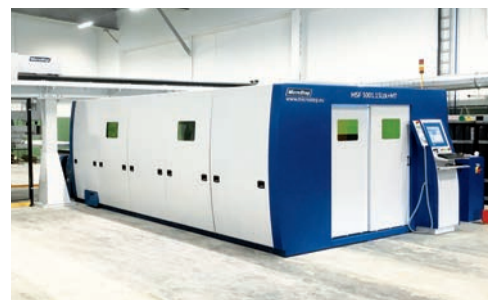
↑ CNC stroj typu MSF na rezanie pevnolátkovým vláknovým laserom
