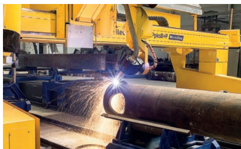
↑ CNC stroj na rezanie 3D dielcov z rúr a profilov plazmou
